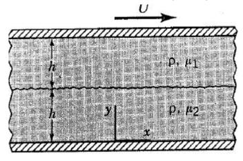
解:如图建立坐标系,根据流动特征可以得到: $v=0, w=0, \frac{\partial p}{\partial x}=0, g_x=0$
